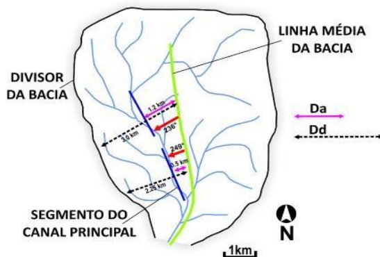
Figura 2: Cálculo do Fator de Simetria Topográfica Transversa. Fonte: Ribeiro, 2010 (Modificado de Cox, (1994).
